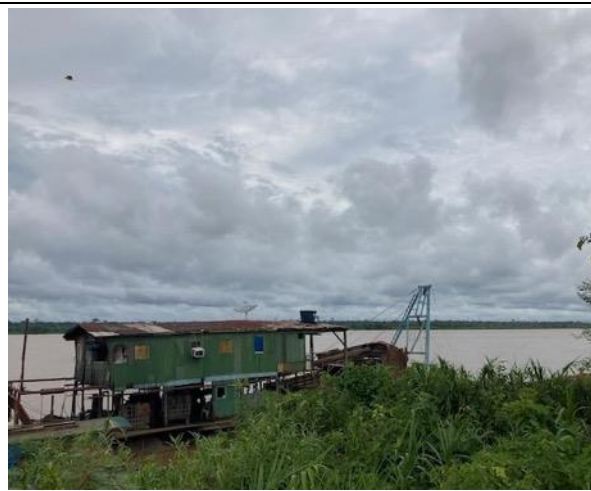
Foto 26: Alojamento da tripulação no topo da barcaça de mineração de ouro
